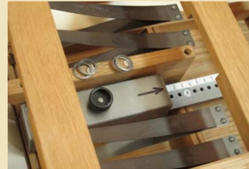
Die **Windanlage** besteht aus einem Ventola, der mehr als 120mmWS leistet und einen einseitigen, regulierten Schwimmerbalg versorgt. Dieser wird mit mehreren Harmoniumfedern belastet und besitzt desweiteren ein Gleitgewicht zur exakt wiederholbaren Feinregulierung. Auf diese Weise wird lückenlos ein Druckspektrum von unter 60mm bis ca. 130mm abgedeckt.
