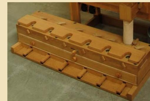
Die unbenutzten Fußlöcher werden im Falle der Labialintonation mit einer Abdeckung verschlossen, die zugleich durch ihre kammähnliche Form das Treffen der Stockbohrung wie auch des Aufrichten der großen Pfeifen dem Intonateur erleichtert. Sind die Holzstiefel montiert, deckt deren Grundplatte die Stockbohrung der Labialen ab.
