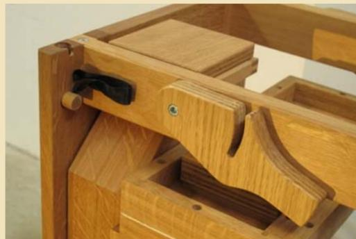
Grundsätzlich sind beiden Hälften so konzipiert, daß es weder oben noch unten überstehende Teile gibt. Keine Passstifte, noch Windkanäle, noch irgendwelche Trakturteile, alles liegt geschützt innerhalb der Gehäusetraversen.
