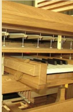
Die **Tontraktur** vereint die beiden Techniken: Sie „sticht“ von der einarmigen Klaviatur aufs Wellenbrett und „hängt“ andererseits unter dem Ventil. Die Ventile sind geschlitzt und mittels Stiften geführt. Sie lassen sich zur Reinigung zügig ausbauen. Die Traktur wird nur im Ventil ausgehängt. Der Ventilkastendeckel wird mittels werkzeugfreien Verschraubungen gehalten und ist auch bei hoher Luftfeuchte problemlos zu öffnen. Eine Tastenfessel kann eingeschaltet werden.
