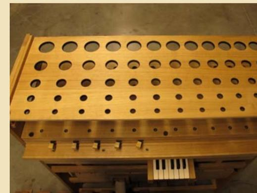
Zweierlei **Pfeifenraster** stehen zur Verfügung: Eines mit leicht konischen, nach oben geöffneten, ausgefilzten Bohrungen für Labiale ab 4' und eines mit engeren zylindrischen, ausgefilzten Bohrungen für Zungen.
