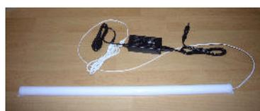
**LED-Leuchtröhre halbrund** 545/560 mm lang, 27 mm breit und 20 mm hoch, bestückt mit 42 hellen Doppel-LEDs in halbrundem opalem Rohr zur idealen Lichtstreuung. Es können auch mehrere Leuchtröhren gekoppelt werden und das Netzteil an einem zentralen Ort verbleiben. Verkabelung dann im 24-V-Schwachstrombereich möglich.
